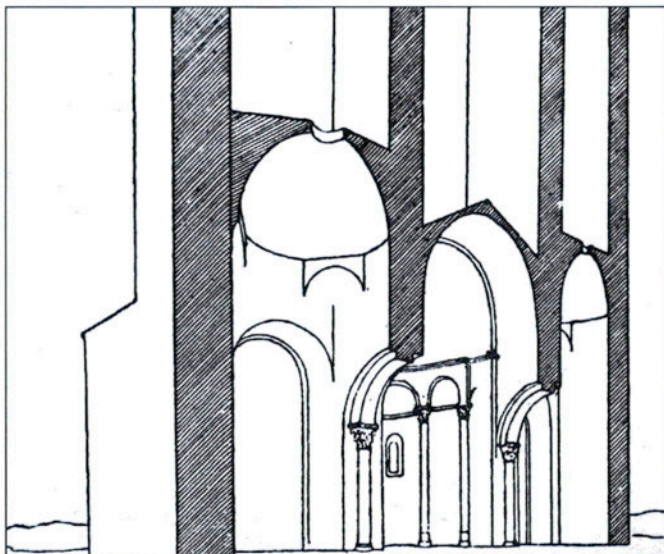
FIGURA 13. Alçat del transsepte, segons dibuix de Josep Puig i Cadafalch (1909-1918). El tram central presbiteral interpreta malament la volta que era de canó transversal.
